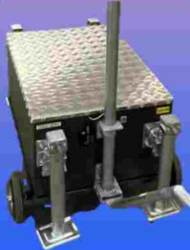
FlashMobil Wagen inklusive Box für Batterien, Computer, Player Modem, Funk, SIM, GPS
